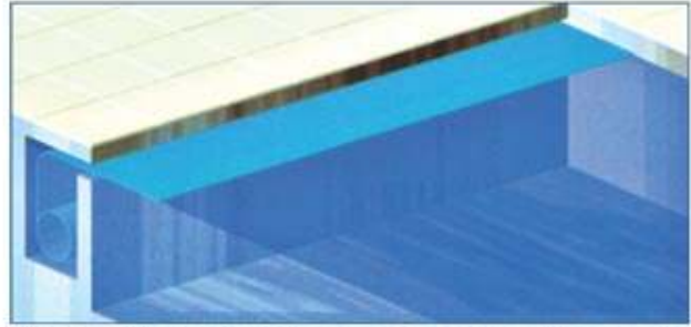
1) Copertura immersa in vano separato dalla piscina
